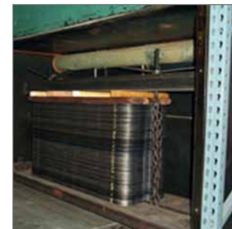
11. Pressatura del pacco piastre con polimerizzazione della colla in forno
