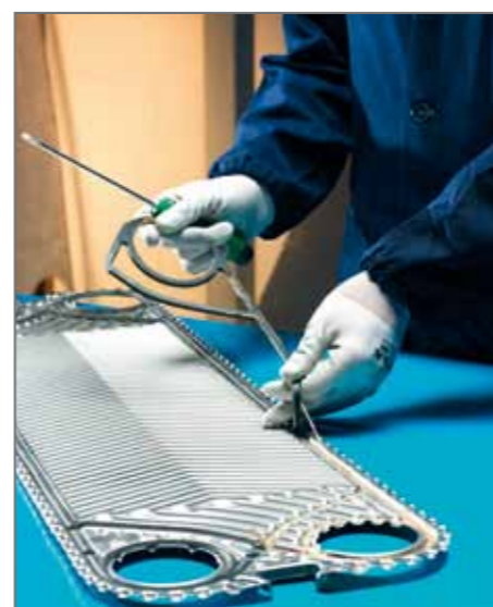
2. Rimozione delle vecchie guarnizioni
