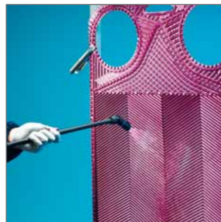
6. Pulizia piastre da liquidi di controllo
