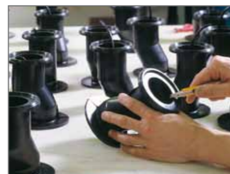
Alcune delle fasi di sbavatura delle guarnizioni
