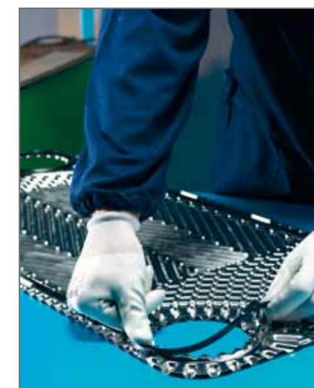
9. Montaggio guarnizioni esenti da colla
