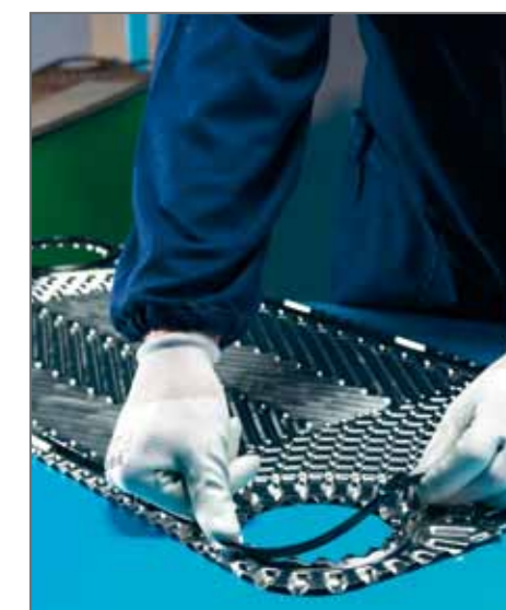
9. Montaggio guarnizioni esenti da colla
