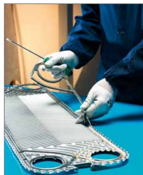
2. Rimozione delle vecchie guarnizioni
