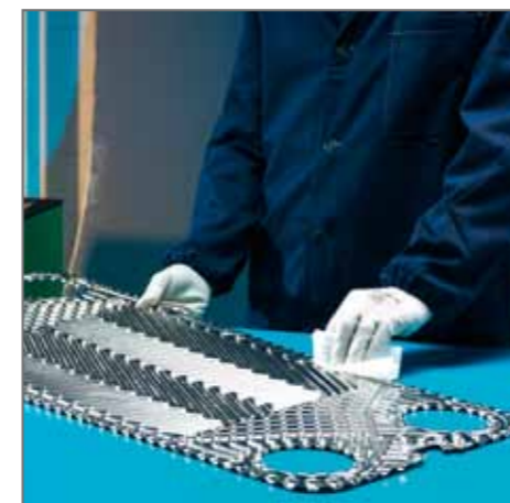
4. Pulizia delle sedi di tenuta delle guarnizioni
