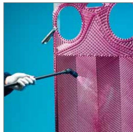
6. Pulizia piastre da liquidi di controllo
